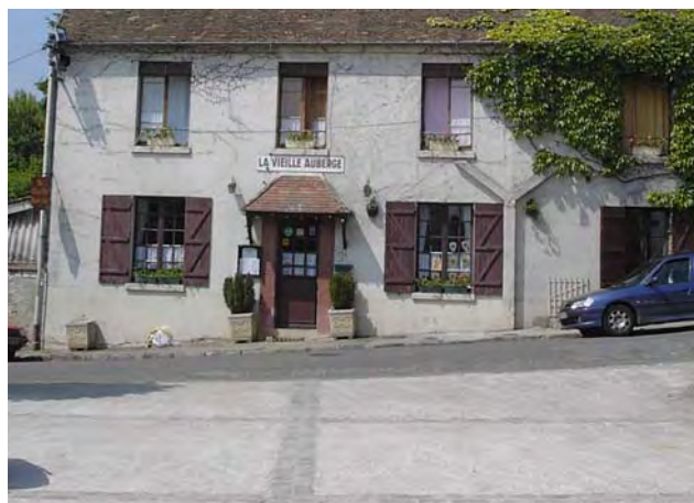
Place de l'Eglise : sol en béton avec un dessin pavé de grès.
